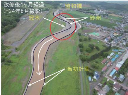
降雨後、緩傾斜掘削を行った箇所に冠水している。また砂州も形成されている。
