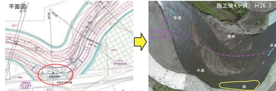
・計画低水路形状に拘らず、現況河岸まで横断形状を拡幅し(河道法線は変更しない)、現況河岸部に直立タイプの護岸設置を行い、瀬・淵の保全を行った。
