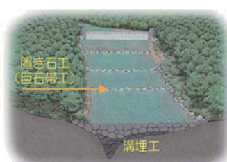
②溝埋工で河床を平らにした後、土砂を捕捉するための置き石工を設置する
