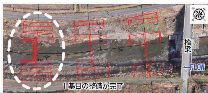
床止工群の設置位置（赤い実線部分）
