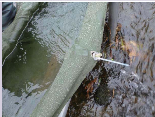
ハトメ部分の破れ (H29. 10. 7)
