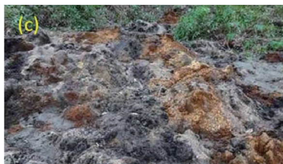
写真 3-4 被災箇所周辺の状況（2018.9.7 撮影）：(b) 図 3-1 (b) から見た崩壊面の状況、(c) 図 3-1 (c) 付近における崩壊土砂の様子 出典：参考文献 1
