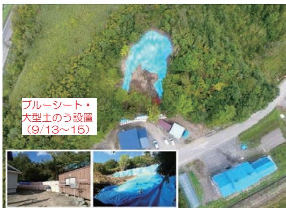
写真1 応急対応の状況 厚真東和2 (急傾斜)
