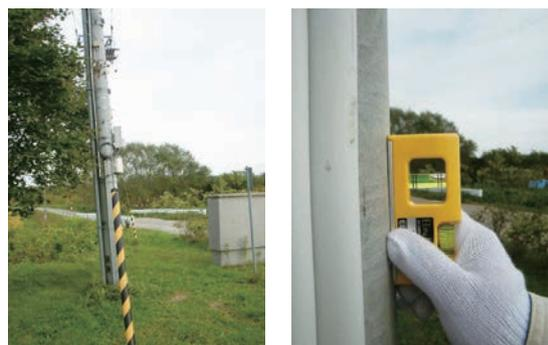
厚真浄化センター 電柱の傾斜
