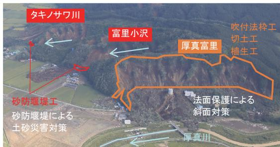
写真5 急傾斜地崩壊対策事業の検討
