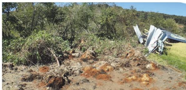
写真9 堆積土の末端状況（先端部で厚さ約1.0m）
