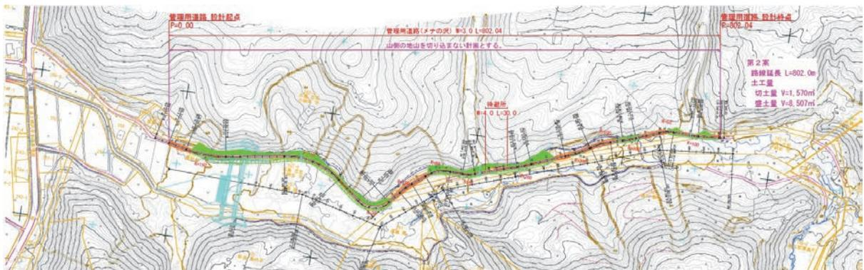
図8 メナの沢川砂防堰堤設置に伴う既設林道の付替 (L=802m)
