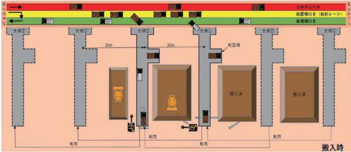
図8 3車線の運用模式図
