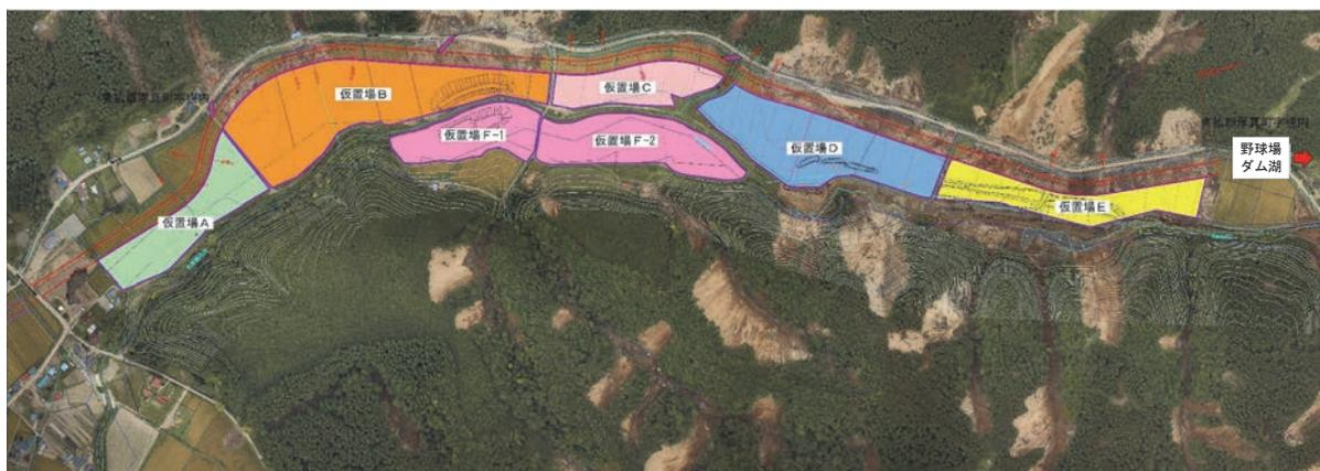
図2 土砂仮置場平面図（A～F）
