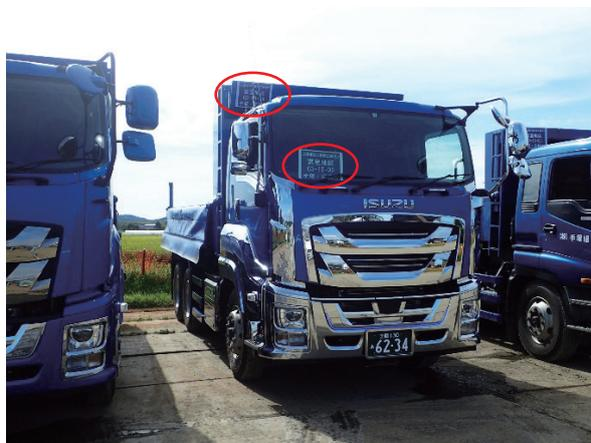
写真3 識別プレートを掲示した工事車両
