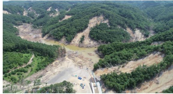
写真1 排水作業中の土砂ダム（令和元年7月）
